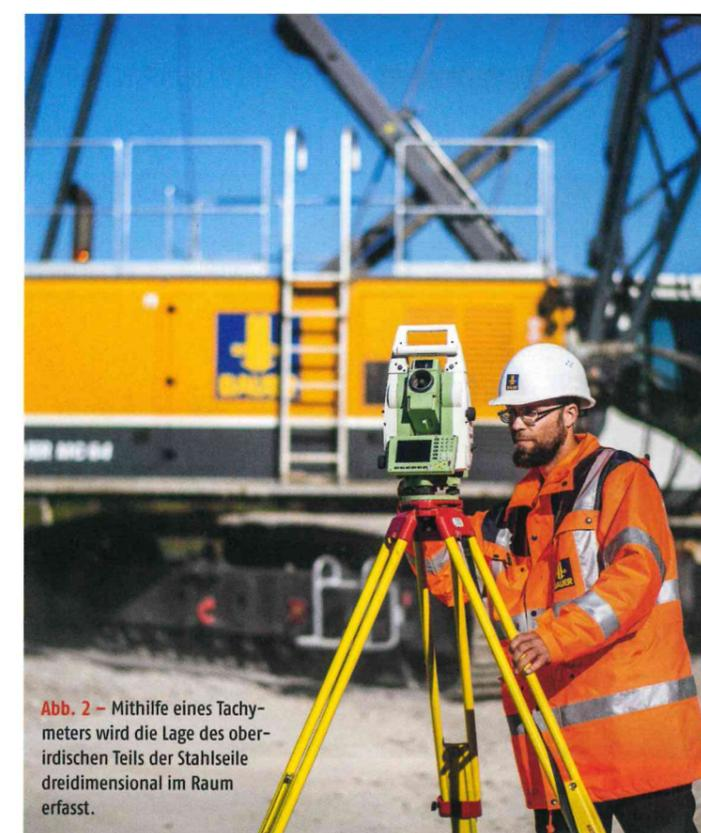
Abb. 2 – Mithilfe eines Tachymeters wird die Lage des oberirdischen Teils der Stahlseile dreidimensional im Raum erfasst.
