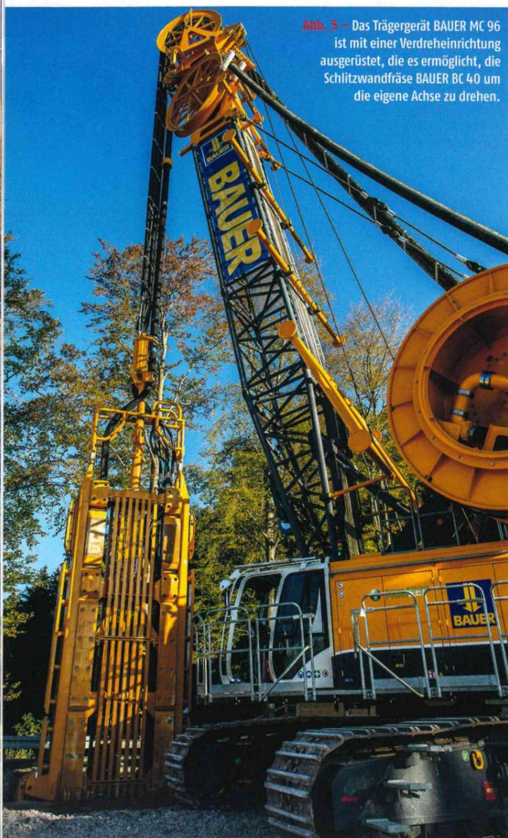
Abb. 5 – Das Trägergerät BAUER MC 96 ist mit einer Verdreheinrichtung ausgerüstet, die es ermöglicht, die Schlitzwandfräse BAUER BC 40 um die eigene Achse zu drehen.
